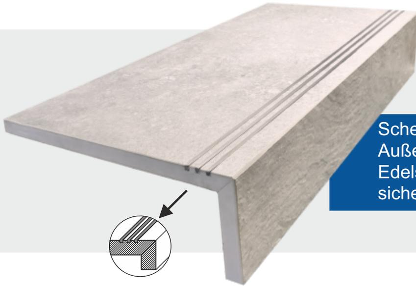
Schenkelplatte aus 2 cm für den Außenbereich mit eingeklebtem Edelstahl zur Verbesserung der Rutschsicherheit und als optische Hervorhebung
